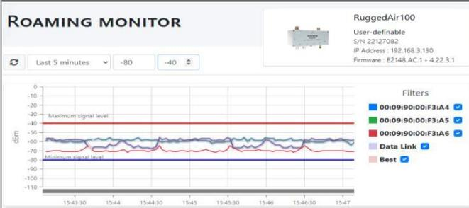
이동설비의 핵심은 로밍. 현재 연결되어 있는 AP와의 실시간 신호세기가 시간별로 그래프를 통해 표시되고, ACKSYS의 Proactive 로밍 (30ms이내)으로 데이터 손실없는 모니터링 기능을 제공합니다.
