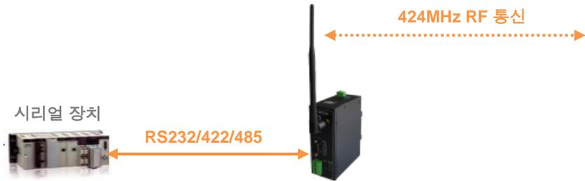
NETWORK>RF>Data Interface 항목을 Serial 로 설정한 상태에서 PERIPHERAL 메뉴의 Operation Mode 를 RF Radio 가 아닌 다른 값으로 설정할 경우 해당 시리얼 포트는 10/100Mbps 네트워크를 통해 시리얼 데이터가 송수신 됩니다. 일반적인 시리얼 디바이스 서버 및 Modbus/TCP Gateway 로 사용할 수 있으며 자세한 설명은 ANIO-SE 제품 매뉴얼을 참고하시기 바랍니다.
