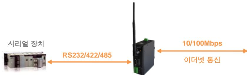
NETWORK>RF>Data Interface 항목을 Network 로 설정할 경우 PERIPHERAL 설정과 상관 없이 시리얼 데이터는 무선 네트워크를 통해 송수신될 수 없으며 이더넷 데이터만 RF 무선 네트워크를 통해 송수신 됩니다.
