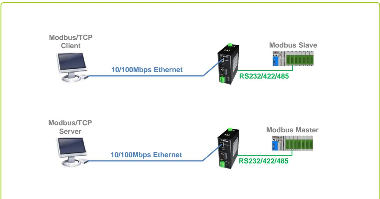
■ Serial-to-Serial 혹은 Modbus-to-Modbus 장치를 이더넷 네트워크로 연결
