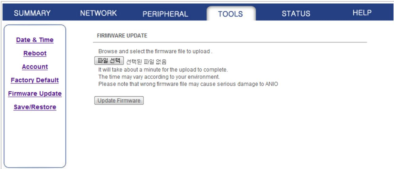
ANIO-SE 제품의 펌웨어는 오류 수정 및 기능 추가로 인하여 버전이 업그레이드 될 수 있습니다. 최신 펌웨어 정보는 당사 홈페이지나 전화 상담을 통해 확인하실 수 있습니다. 펌웨어는 ANIO-SE 제품의 플래시 메모리에서 동작하는 어플리케이션으로서 사용자가 직접 펌웨어를 업데이트 할 수 있습니다. 최신 펌웨어를 확인하신 후 업데이트 작업에 사용할 컴퓨터에 최신 펌웨어 파일을 저장합니다. '파일 선택' 버튼을 클릭하여 저장된 펌웨어 파일의 위치를 지정한 후 'Update Firmware' 버튼을 클릭합니다. 선택한 펌웨어는 이더넷을 통해 ANIO-SE 제품에 업로드 됩니다. 컴퓨터에서 ANIO-SE 제품으로 펌웨어 파일 전송이 완료되면 약 60 초 이내에 새로운 펌웨어를 플래시 메모리에 저장한 후 자동으로 재시작 됩니다.
