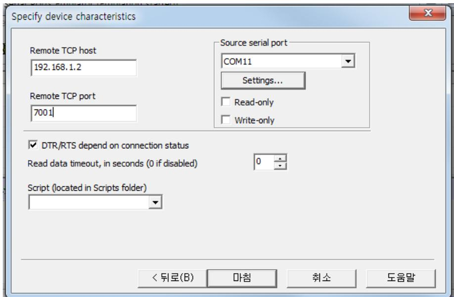
아래의 화면은 PC 에 가상의 COM11 포트가 생성된 상태를 표시합니다. COM11 포트는 192.168.1.2 IP 주소로 설정된 ANIO-SE 제품의 7001 번 TCP 소켓으로 데이터를 송수신하게 됩니다.
