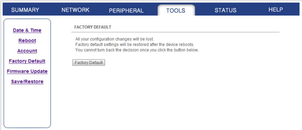
ANIO-SE 제품의 모든 설정 값을 공장 출하 시 초기 상태로 변경합니다. 'Factory Default' 버튼을 클릭하면 기존에 변경된 모든 설정 값이 삭제되고 기본 값으로 변환되어 자동으로 재시작 됩니다. Factory Default 작업 이후에는 이전 설정 상태로 다시 복구할 수 없으니 주의하시기 바랍니다. 초기화가 완료되면 192.168.1.2 기본 IP 주소로 변경되오니 제품 접속에 사용되는 컴퓨터의 네트워크 정보를 확인하시기 바랍니다.
