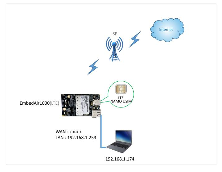
LTE USIM이 탑재된 EmbedAir1000(LTE) 제품을 통해 PC가 인터넷에 연결되는 예시입니다. 가입한 LTE 상품에 따라 고정공인 IP 또는 사설유동 IP를 부여받을 수 있으며, 이에따라 EmbedAir1000 (LTE) 제품은 서버 또는 클라이언트로 동작되어 거리에 제한 없이 LTE망을 통해 적절한 네트워크망을 구축 하실 수 있습니다.
