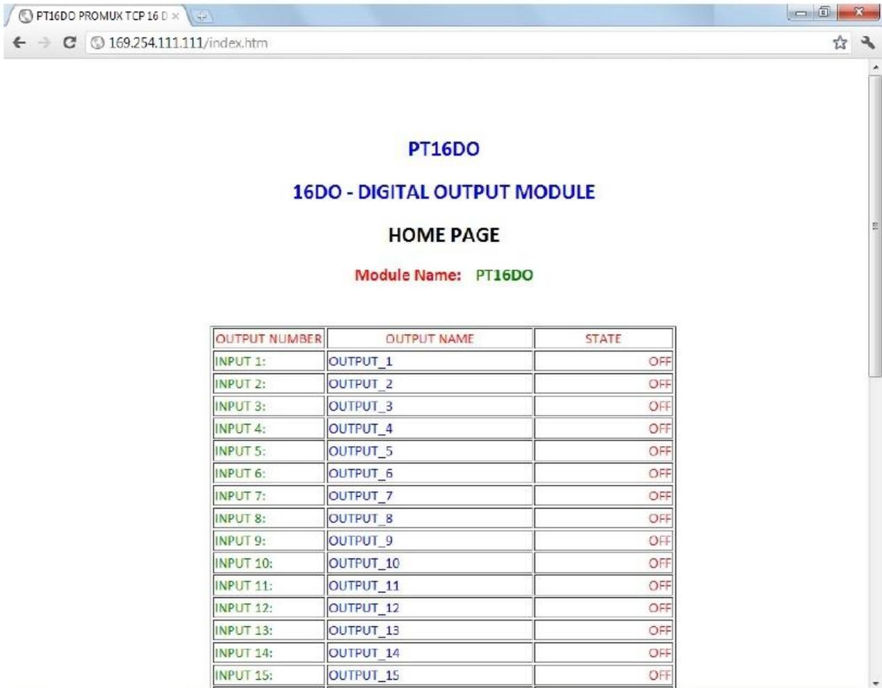
웹 페이지가 표시되지 않으면 ping 명령을 통해 PC와 PROMUX TCP 모듈이 정상적으로 연결되어 있는지 확인하시기 바랍니다. PC에 방화벽이 설치되어 있을 경우 설정 메뉴에서 프록시 서버를 선택하시기 바랍니다. PC와 PROMUX TCP 제품이 네트워크를 통해 연결된 경우에는 웹 브라우저의 설정 메뉴에서 "direct connection to the network" 또는 "bypass proxy server for local addresses" 항목을 선택하시기 바랍니다.
