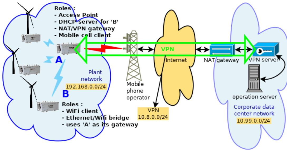
'B' 장치는 게이트웨이 'A'와 데이터 센터의 VPN 서버 모두에서 라우팅 테이블이 허용하는 IP 주소에만 액세스할 수 있습니다. 게이트웨이 제품 'A'는 일반적으로 모든 트래픽을 VPN 서버로 전달하도록 설정됩니다. 그러나 VPN 외부의 특정 인터넷 위치에 대한 액세스를 허용하는 예외가 포함될 수 있습니다. VPN 서버(데이터 센터에 있는)는 일반적으로 선택된 운영 서버 그룹으로 전달을 제한하여, 원격 장치가 승인되지 않은 컴퓨터에 액세스하는 것을 금지하고, 그 반대의 경우도 마찬가지입니다.
