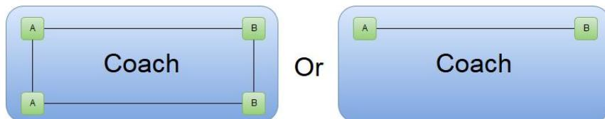
중복 혼합 모드의 경우 객차 엔드 유형은 관련이 없습니다. 이 모드에서, 캐리지 간 이더넷 링크는 열차의 모든 장치를 한 번에 검색할 수 있는 방법을 제공합니다. 토플로지 검색이 끝나면 각 제품에는 열차의 모든 장치 목록이 표시됩니다. 자체 열차의 제품을 알면 SRCC는 무선 링크를 설정할 때 나열되지 않은 제품(즉, 다른 열차의 제품)을 제외할 수 있습니다.
