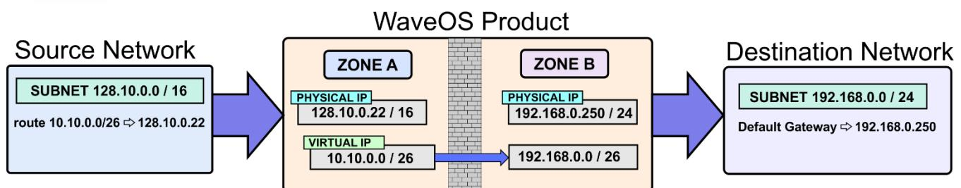
이제 전체 192.168.1.0 서브넷에 대한 액세스를 추가하고 고유한 192.168.2.0 서브넷 주소에 연결하려면 가상 주소를 추가하고 적절한 변환 규칙을 정의하기만 하면 됩니다. 그러나 정적 경로 또는 기본 게이트웨이를 통해 반환 경로를 정의할 수 있으려면 대상 인터페이스에서 각 서브넷에 대한 제품의 IP 주소 별칭을 만들어야 합니다.
