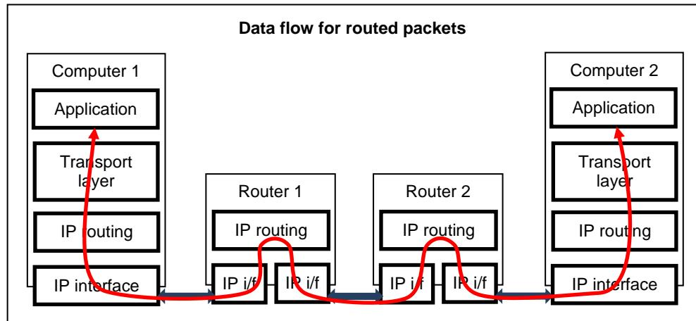
WaveOS에서 라우팅은 여러 네트워크 인터페이스가 구성되었을 때 수행됩니다. ROUTING/FIREWALL 서브메뉴에서 자세한 내용을 확인할 수 있습니다. 참조: [Routing / Firewall](#)
