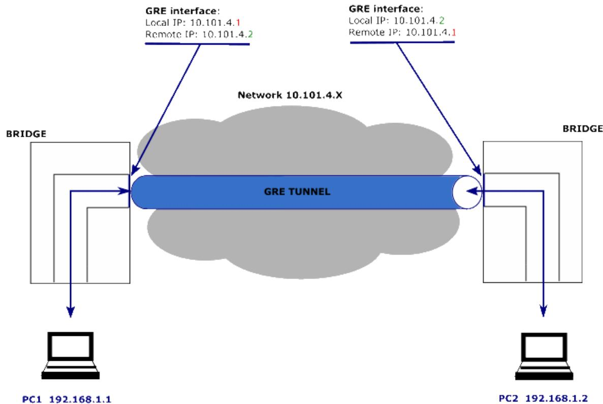
Layer 2 tunneling over GRE 는 VIRTUAL INTERFACES/L2 TUNNELS 로 구성할 수 있습니다.
