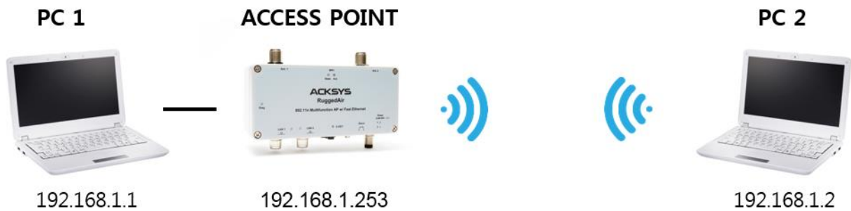
ACKSYS AP 장치의 기본 설정값(802.11gn, SSID "acksys", no security).
